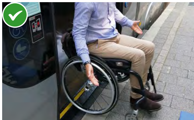
Le nez-fusible supprime la lacune horizontale entre le quai et le tram
