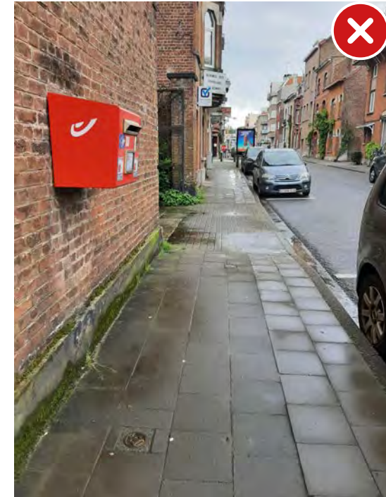
Boîte aux lettres dépassant de 34 cm du mur et constituant un objet saillant à sécuriser
