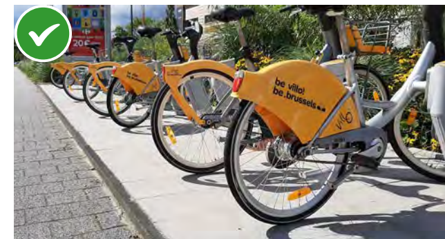
Stationnement Villo! placé le long de la ligne guide naturelle mais équipé d'une bordure de 5 cm détectable à la canne par une personne déficiente visuelle
