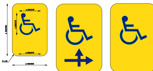
Signalisation pour un couloir de contournement indiquant un accès PMR
