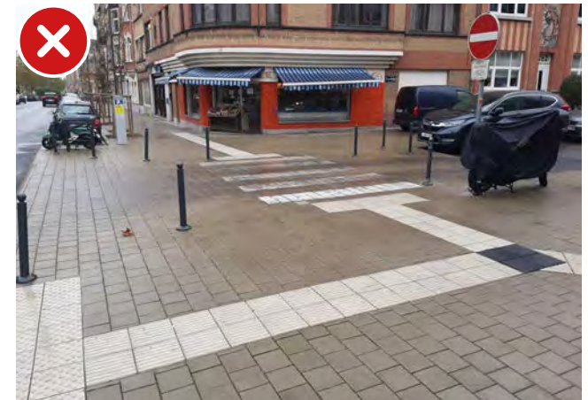
Aucun marquage d'un passage piéton ne peut être tracé sur un trottoir traversant
