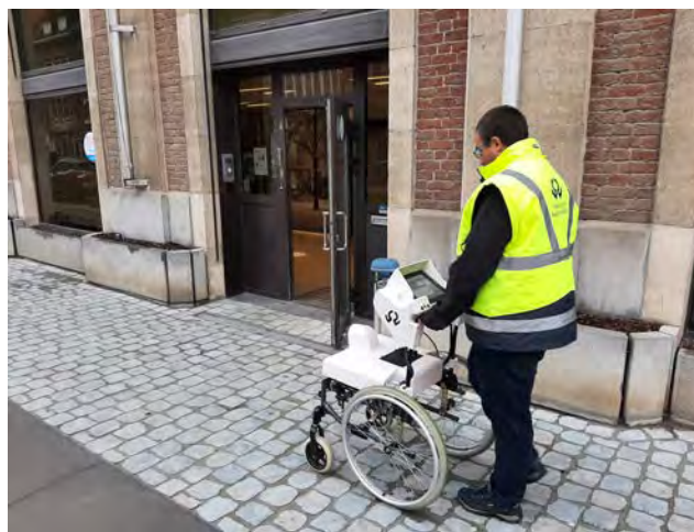
La chaise de mesure permet d'objectiver le confort des revêtements piétons
