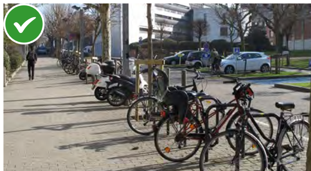
Arceaux en U inversé placés en trottoir, du côté opposé à la ligne guide naturelle, et laissant un libre passage supérieur à 2 m
