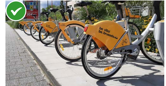
Villo!-parkeerplaats naast de natuurlijke gidslijn, maar met een boordsteen van 5 cm die door een slechtziend persoon met een witte stok kan worden gedetecteerd
