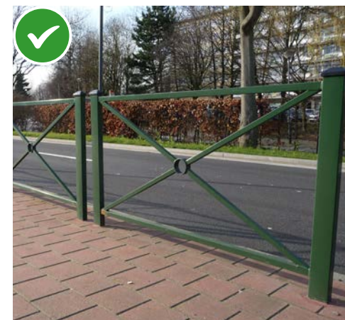
Conforme afsluiting van het type "andreaskruis"
